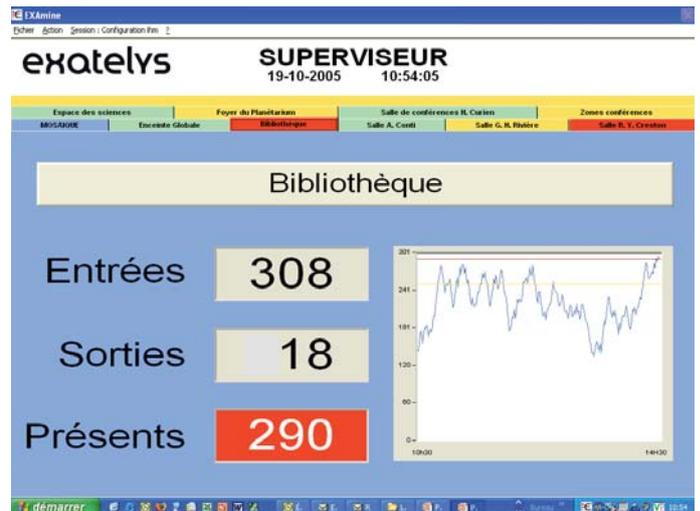
La gamme de capteurs SIRA contribue à répondre aux exigences légales de sécurité des lieux publics. Le capteur est installé de façon discrète au dessus de chaque accès des zones à surveiller. Relié à un serveur base de données, il permet la supervision en temps réel du bâtiment en gérant le taux de remplissage des différents espaces contrôlés.
